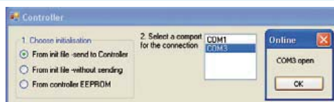
Bild 3. Im Startfenster wird der COM-Port eingestellt, ferner ist die Quelle der Initialisierung (EEPROM oder PC-Datei) wählbar.
