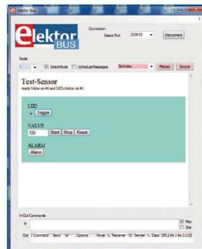
Bild 7. Die PC-Software simuliert die externe (Mess-)Elektronik.
