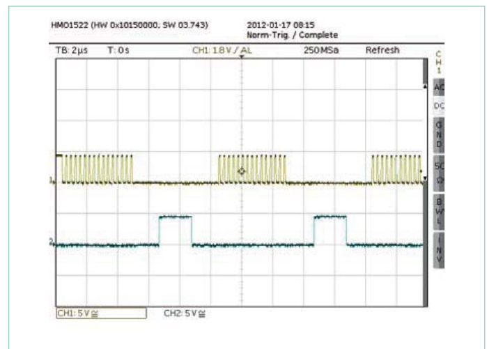
Bild 6. Messung des Interrupt-Timings.
