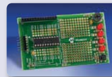
PICkit™ Demoplatine für geringe Anschlusszahlen - DM164120-1
