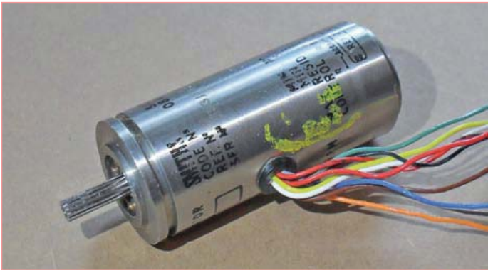
Bild 8. Ein Motor/Tachogenerator aus dem HSI.
