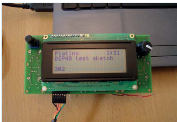
Bild 3. Test-Sketch von Bild 2, auf Platino laufend. Der Wert unten links (302) entspricht dem Status des Dreh-Encoders rechts. Der Timer-Wert oben rechts kann durch Betätigung des Tasters links zurückgesetzt werden.
